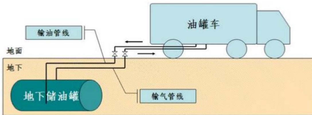
图 2-2 卸油油气回收系统示意图
