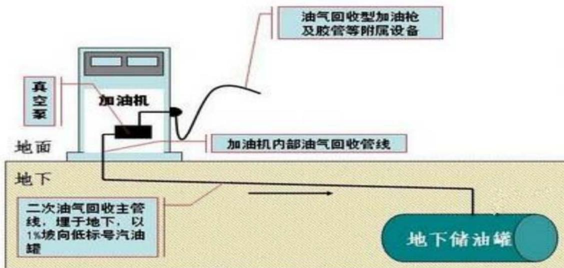
图 2-3 加油油气回收系统示意图
