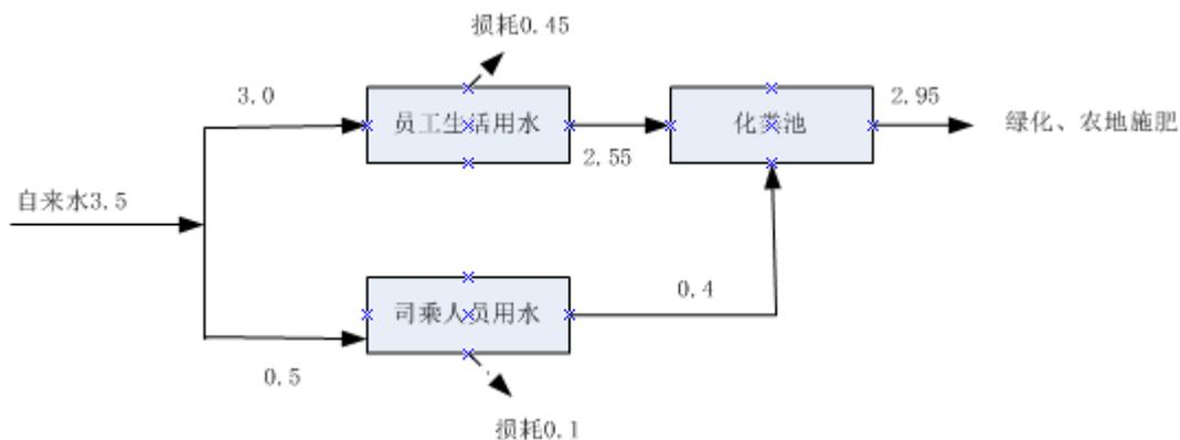
图 1-1 本项目水平衡图 (m<sup>3</sup>/d)
