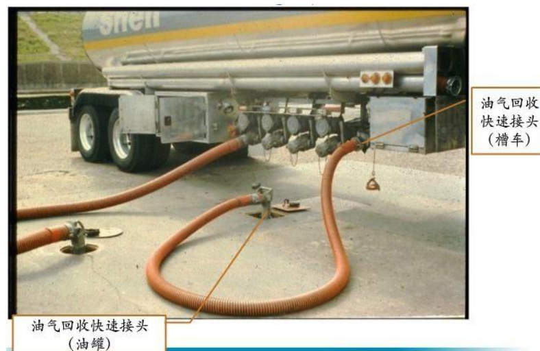
图 2-4 一次油气回收实例图
